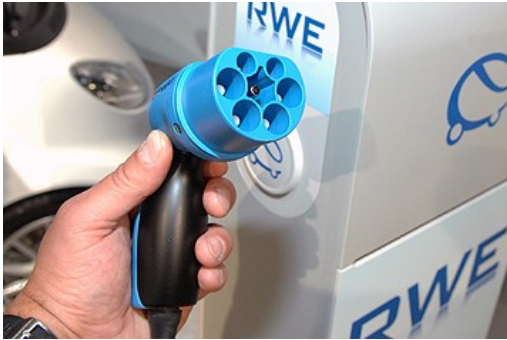
Βύσματα IEC 62196-2 Τύπος 2 με επτά ακροδέκτες κατασκευής Mennekes
