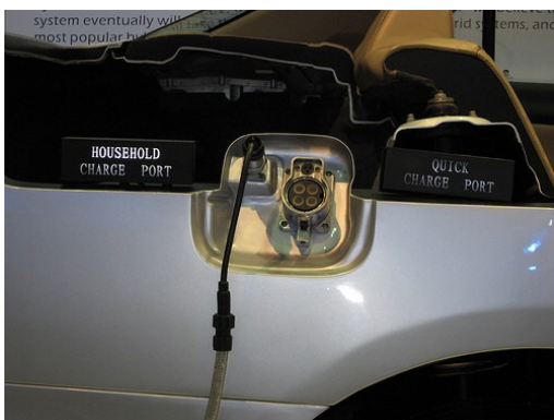
Υποδοχές ήπιας και ταχείας φόρτισης σε αυτοκίνητο Tesla
